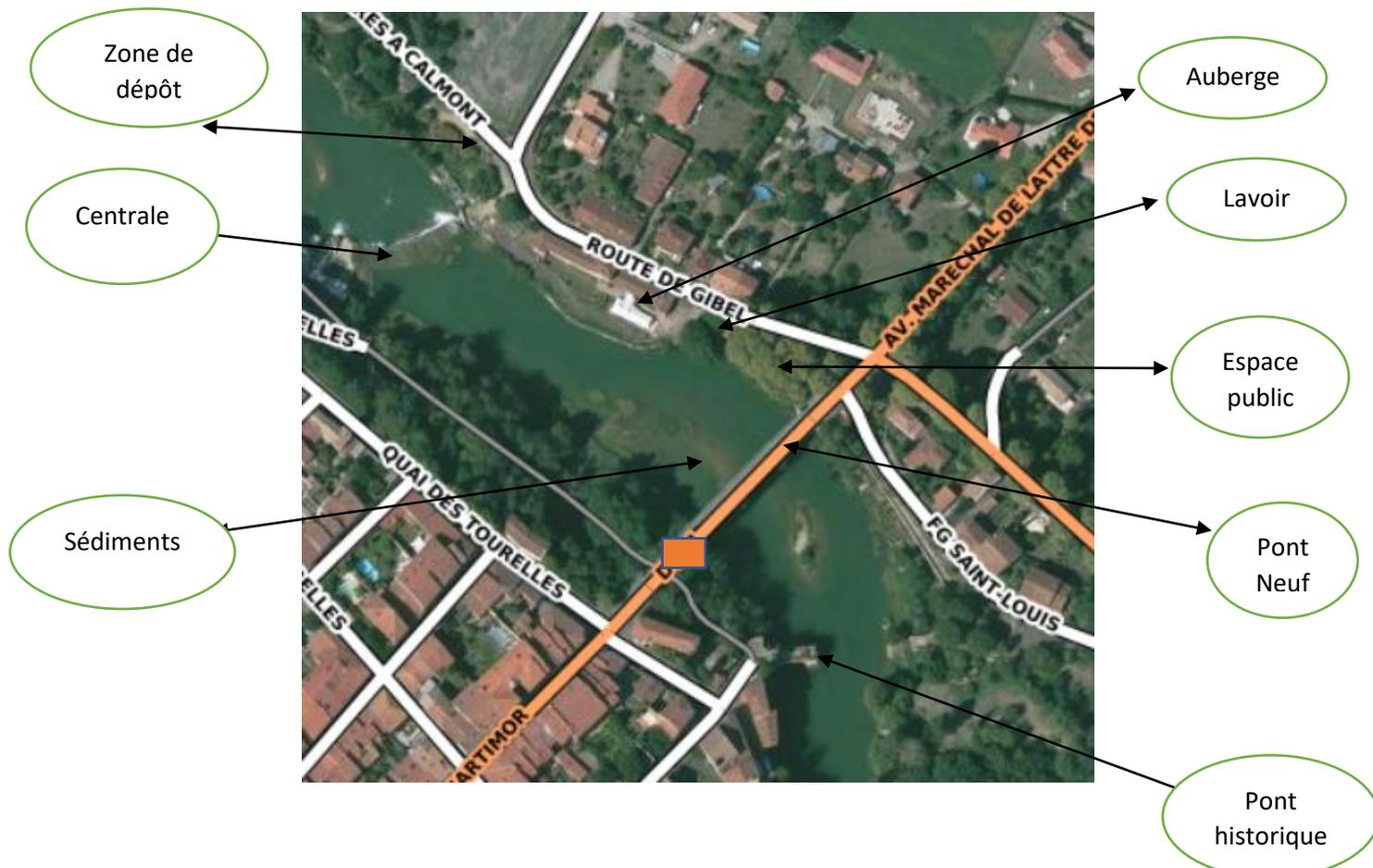
Le chenal principal se divise en deux chenaux longeant la rive gauche (RG) et la rive droite (RD), avec des vitesses d'écoulement différentes (réduite à gauche, et élevée à droite) ; on constate une tendance à l'envasement du lit entre les restes du pont historique et la microcentrale avec dépôt de sédimentation.
